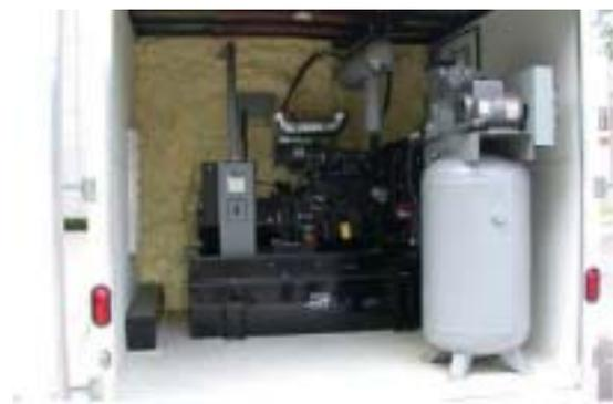
图 15 空压机放置于车一端,两侧为车门
